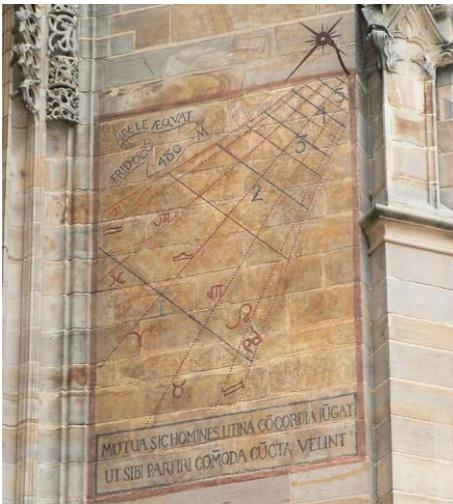
Le cadran doit être placé sur un mur vertical, faisant face à l'ouest.
