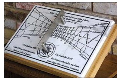
Orologio solare polare con lemniscate di tempo medio, realizzato da Dan O'Neal per la città di Santa Avelina in Guatemala
