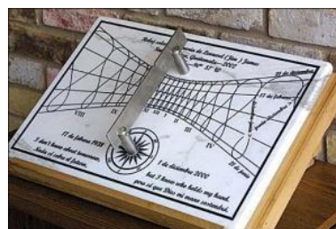
Cuadrante polar con curvas en ocho de tiempo medio, realizado por Dan O'Neal para la ciudad de Santa Avelina en Guatemala
