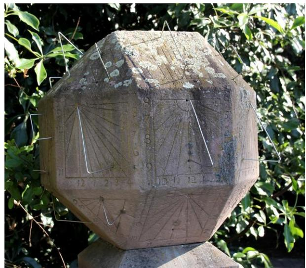
Eine Mehrfachsonnenuhr mit 26 Flächen auf einem Polyeder namens Rhombenkuboktaeder, einem Würfel mit abgestumpften Kanten. Ein aktuelles Beispiel einer solchen Sonnenuhr ist im Botanischen Garten von Straßburg in der Nähe des Observatoriums und des Planetariums zu sehen. Die in Shadows implementierte Version hat tatsächlich 22 Flächen, da die drei zum Boden geneigten Flächen kein Sonnenuhr-Layout haben.
