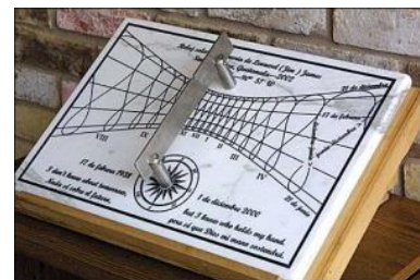
Polare Sonnenuhr mit Analemmata, gebaut von Dan O'Neal für die Stadt Santa Avelina in Guatemala
