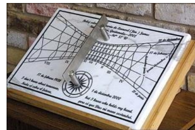
Cadran polaire avec courbes en huit de temps moyen, réalisé par Dan O'Neal pour la ville de Santa Avelina au Guatemala
